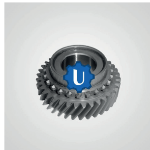
165A - Engrenagem 5ª Marcha Logan / Sandero - Motor 1.6 8 Ou 16v
